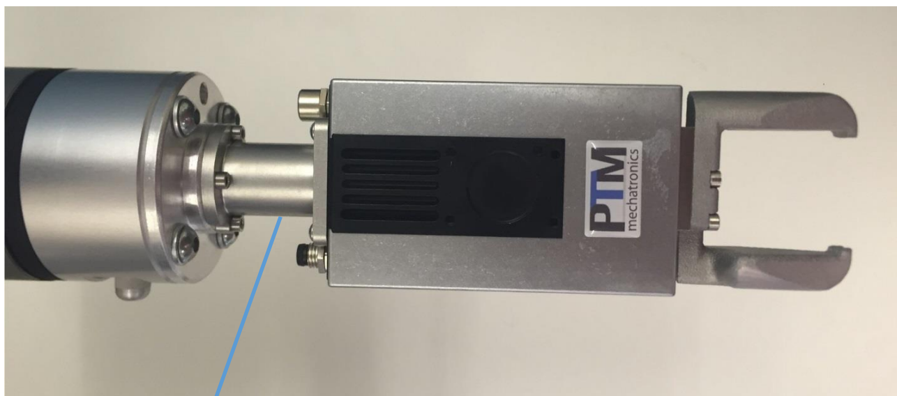
Aktywny hamulec magnetyczny wbudowany w kołnierz robota.
